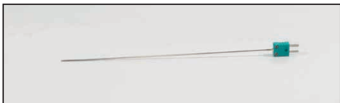
Thermocouple chemisé, Ø 1,5 mm, Matériau de chemisé Inconel (2.4816), modèle KM
